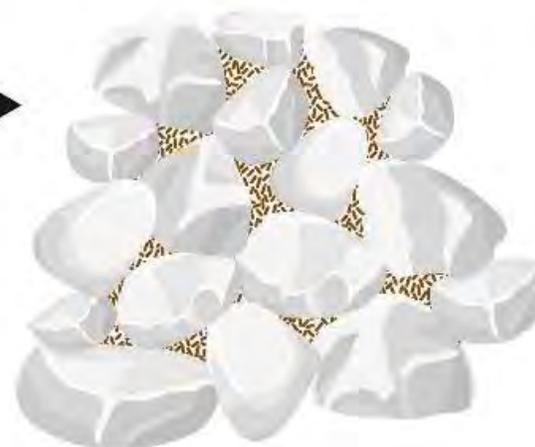
Wurzelraum in den Hohlräumen des mineralischen Stützkorns, dazwischen Bodenluft sowie Wasser und Nährstoffe an das Schwemmsubstrat gebunden
