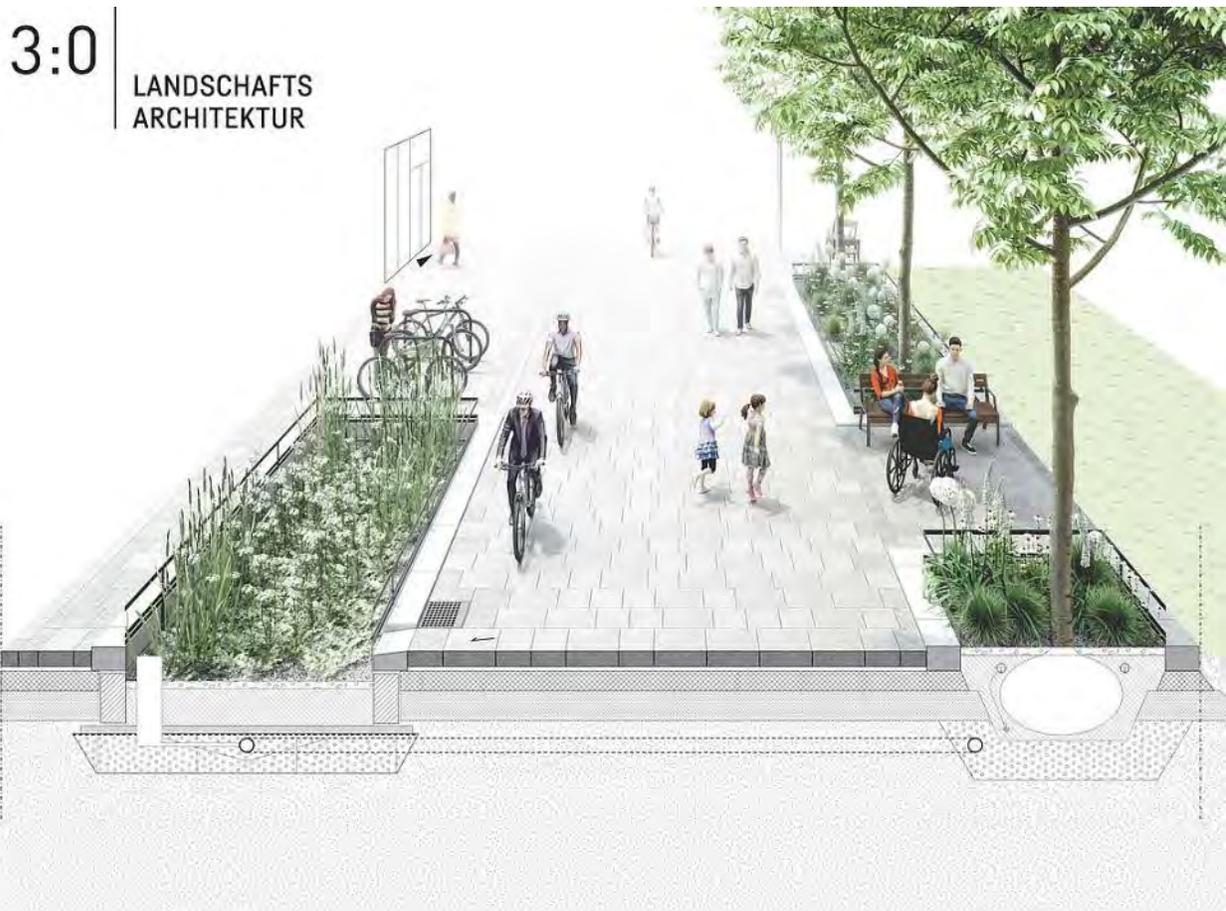
Schwammstadtprinzip mit Wasserreinigung in Tiefbeeten
