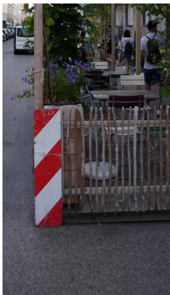
Abbildung 3 Absicherung mit Leitplatten © Green City e.V., Frese
