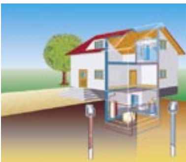
Tiefensensoren einer Wärmepumpe
