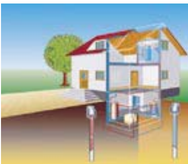
Tiefensensoren einer Wärmepumpe
